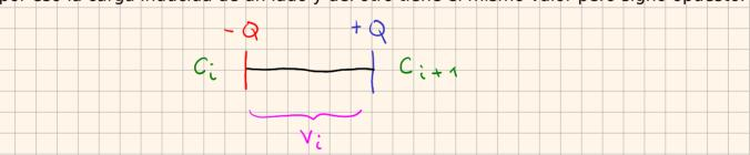
La diferencia de potencial entre los términales o bornes A y B es la suma de las diferencias de potencial entre cada una de las caras de todos los capacitoes
