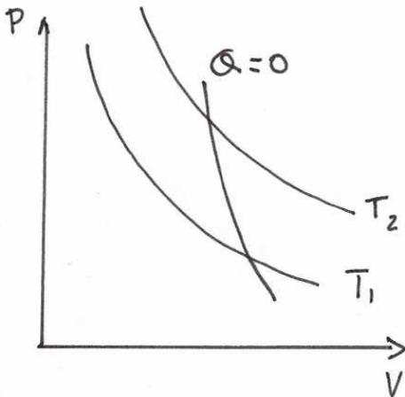
Notar que, en una compresión adiabática, la temperatura puede aumentar mucho. Esto es lo que se utiliza en los motores diesel. En los cilindros, el aire se comprime hasta 1/15 de su volumen. La temperatura aumenta tanto que el combustible inyectado en el cilindro hace combustión sin necesidad de una chispa.
