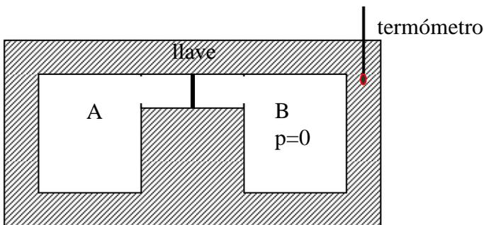
Calorímetro: recipiente con dos cámaras A y B comunicadas por un tubo. En A hay un gas suficientemente diluido como para considerarlo ideal. En B, vacío. Una vez alcanzado el equilibrio térmico, se abre la llave de paso, hasta que  $p_A = p_B$ . Se produce un ligero cambio en la lectura del termómetro  $\Rightarrow$  no se produce prácticamente
