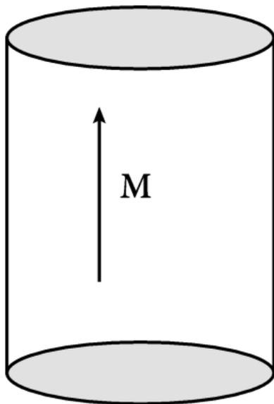
El equivalente magnético del capacitor plano es un cilindro con magnetización  $\mathbf{M}$  constante paralela al eje del cilindro. Las ecuaciones son
