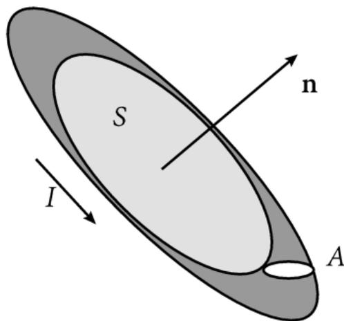
Figura: Momento dipolar de una espira de corriente
