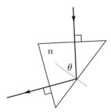
intensidad del rayo emergente es  $16n^2/(1+n)^4$  veces la intensidad incidente, donde n es el índice de refracción del prisma. Demostrar que el rayo emergente está elípticamente polarizado, con un desfasaje  $\tan\frac{\phi}{2}=\frac{\cos\theta}{(\sin\theta)^2}\,\sqrt{(\sin\theta)^2-n^{-2}},$
