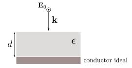
10. Una onda plana linealmente polarizada de amplitud  $\mathbf{E}_0$  incide normalmente desde el vacío sobre una lámina de espesor d de un muy buen conductor ( $\delta << \lambda$ ). Puede asumirse que  $\epsilon = \mu = 1$  en todo el espacio.
