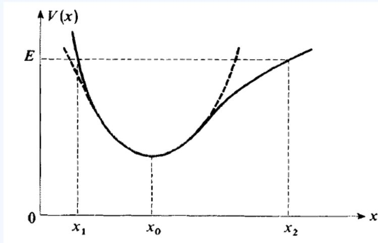
$$V(x) = a + \underbrace{b(x - x_0)^2}_{\text{oscilador armónico}} + \underbrace{c(x - x_0)^3 + \dots}_{\text{anarmonicidad}}$$
