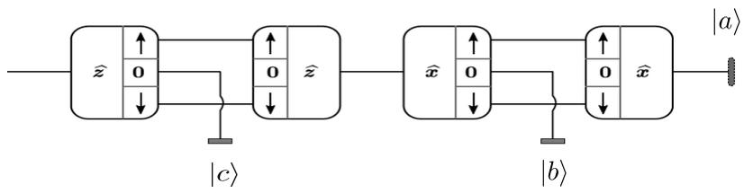
**Figura 2:** Aparato que usa Stern Gerlach para medir los tres operadores  $\{L_x^2, L_y^2, L_z^2\}$ . El segundo y cuarto Stern Gerlach tiene el campo magnético invertido (juntan los haces).
