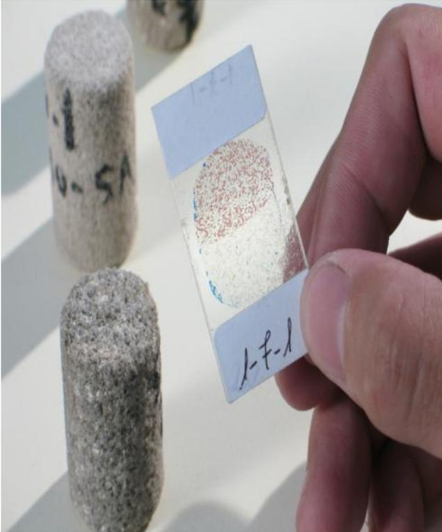
Es el área de soporte de los laboratorios de PyMF e Ensayos Especiales. Es de vital importancia en la industria de petróleo conocer la geología de las rocas, dado que los minerales que componen la matriz rocosa pueden afectarse con los líquidos que se inyectan al pozo de petróleo.
