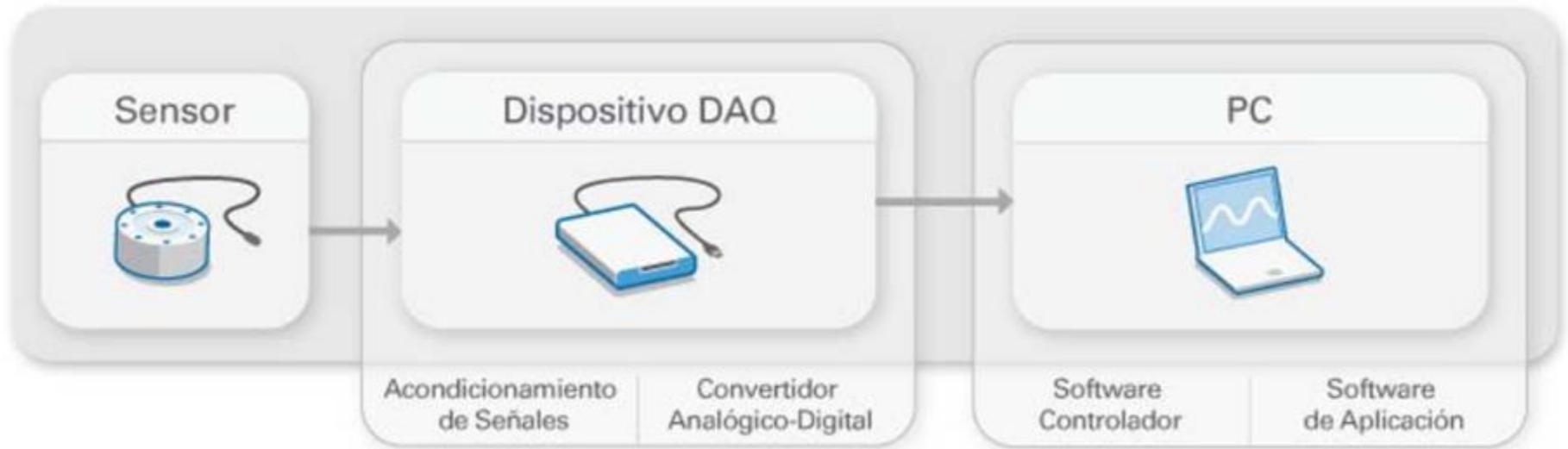
Figura 1: Partes de un sistema DAQ.
