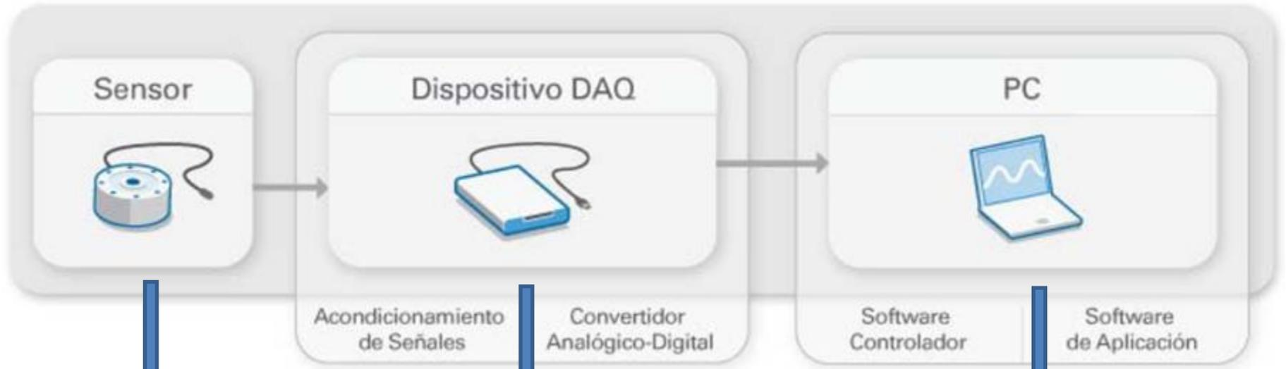
Figura Partes de un sistema DAQ.
