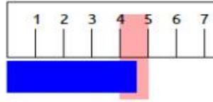
→ **Error de Exactitud ( $\sigma_{ex}$ )**: asociado con el error de calibración del instrumento
