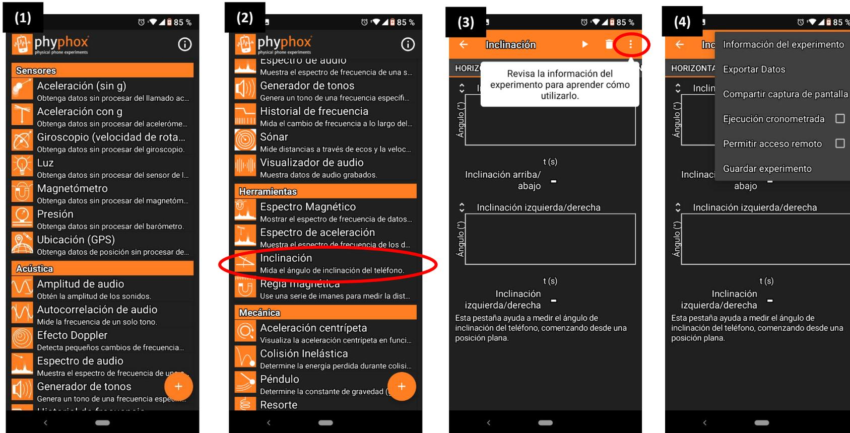
Mida en plano inclinado (5). Comience a adquirir datos oprimiendo play (6). Estará midiendo el ángulo de inclinación en la posición actual respecto de la horizontal en función del tiempo (evaluar la frecuencia de muestreo). Se recomienda colocarlo sobre la mesa de trabajo cuando el plano está horizontal, para tomar el dato del ángulo que considera "zero". Puede exportar los datos en diferentes formatos desde los 3 puntitos (7).
