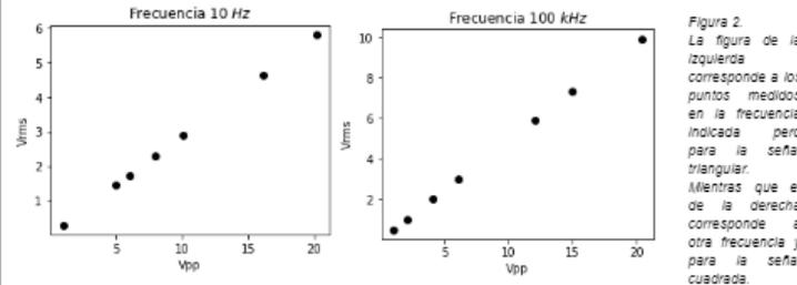
Cómo se puede ver, independientemente de la frecuencia y de la señal que medimos, la relación entre  $V_{pp}$  y  $V_{rms}$  era del tipo lineal. Es por esto que optamos por incluir las incertezas correspondientes a cada medición y aproximar los puntos por una función lineal. Hicimos esto para los 7 puntos correspondientes a cada frecuencia (6 en total) y para cada señal. (18 gráficos en total).
