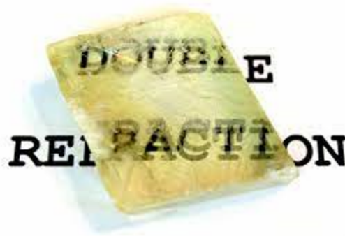
Figura 6.14: Dobles refracciones en la calcita
