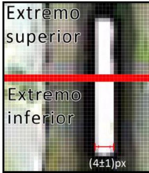
Medición  $b = (180 \pm 10) \mu\text{m}$
