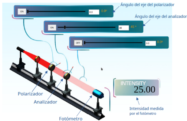
Figura 7: Captura de pantalla del simulador para estudiar la ley de Malus.
