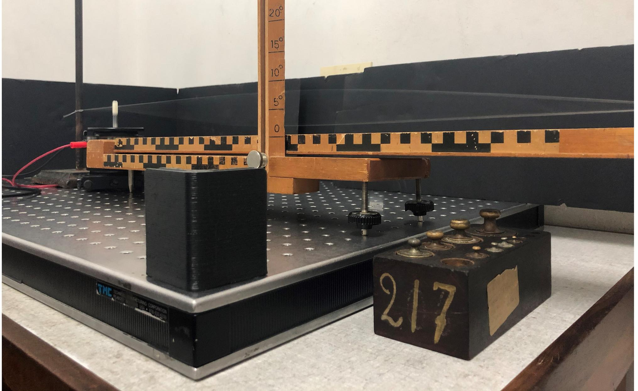
Figura 7. Fotografía con el detalle de una cuerda vibrando en el modo fundamental, ya que en el largo de la cuerda entra sólo media longitud de onda. Hacia el extremo más lejano, se observa el "wave driver" y su vástago blanco. En primer plano un juego de pesas que se usa para variar la tensión de la cuerda.
