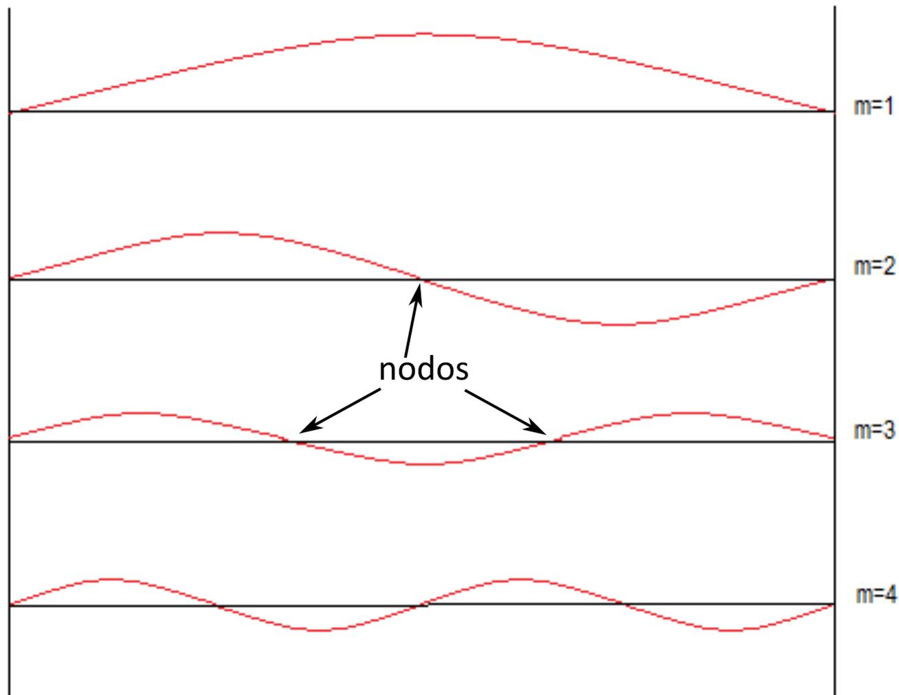
Figura 1. Esquema de los modos normales de una cuerda con los extremos fijos vibrando a distintas frecuencias. En el modo fundamental ( $m = 1$ ) la longitud de onda es 2 veces la longitud de la cuerda,  $L$ . En los demás modos (denominados armónicos) la longitud de onda es  $\lambda = 2mL$  siendo  $m$  un número entero, de manera que las frecuencias son múltiplos enteros de la frecuencia del modo fundamental.
