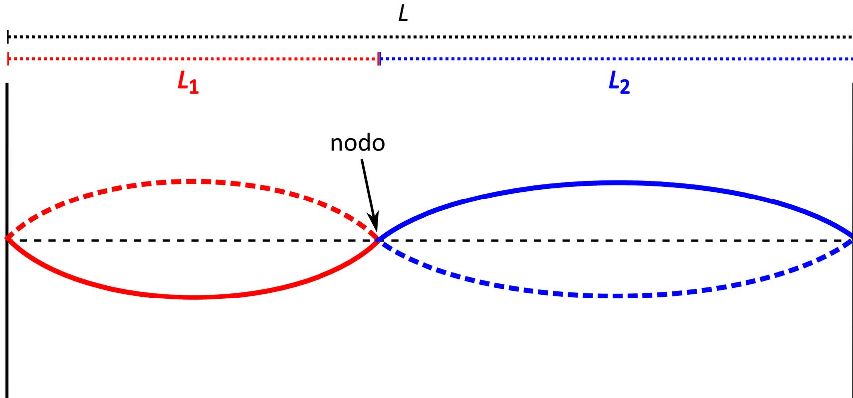
Figura 2. Dos cuerdas de distinta longitud y densidad lineal de masa (representadas en rojo y azul) están unidas entre si, y los otros extremos se mantienen fijos. Se encuentra que a una dada frecuencia existe un modo normal tal que el punto de unión es un nodo y hay media longitud a cada lado de éste. La relación entre las longitudes,  $L_1$  y  $L_2$ , es función de la relación de la densidad lineal de masa de las cuerdas (ver texto).
