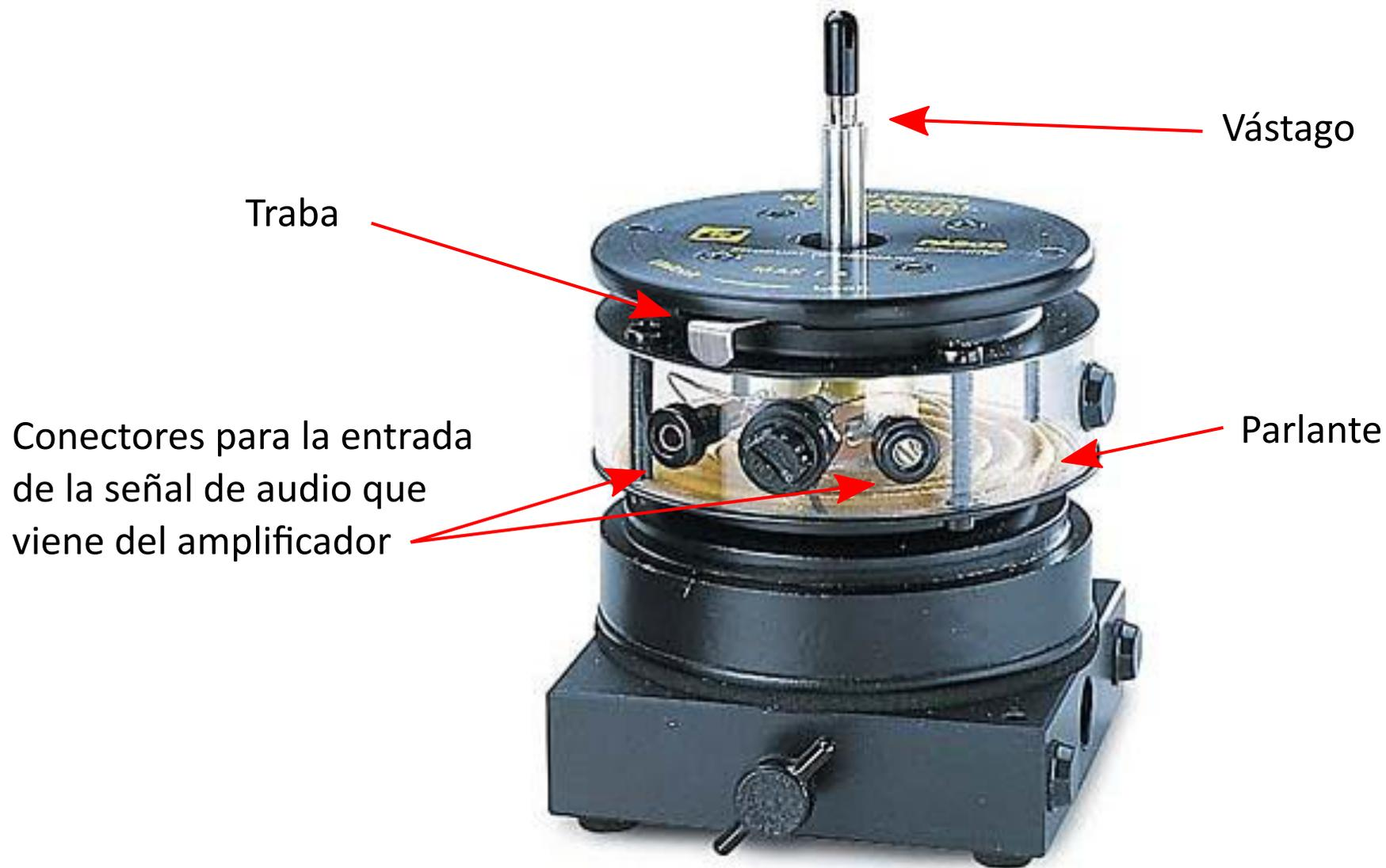
Figura 5. Wave driver para forzar el movimiento de la cuerda. Es básicamente un parlante que posee un vástago en el eje, que al oscilar a la frecuencia del amplificador que lo alimenta, produce un movimiento en la cuerda de la misma frecuencia.
