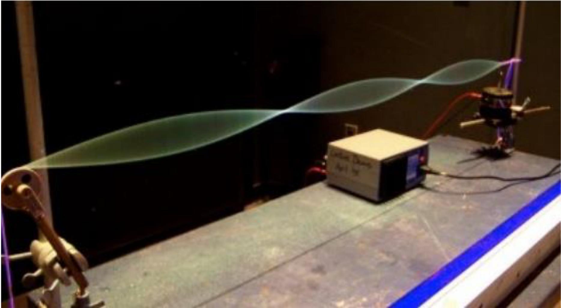
Figura 8. Fotografía con el detalle de una cuerda vibrando en el segundo armónico, ya que en el largo de la cuerda entran 3 medias longitudes de onda. Hacia el extremo más lejano, se observa el "wave driver" y en primer plano la polea de la cual cuelgan las pesas.
