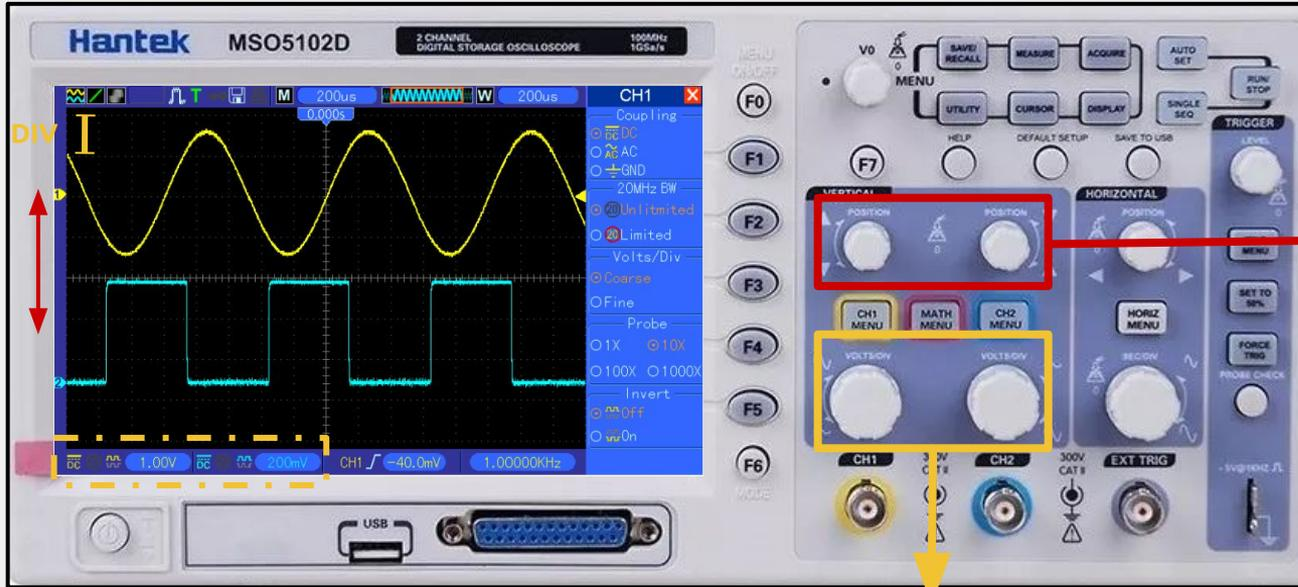
Controlamos la posición (vertical) de la señal en la pantalla
