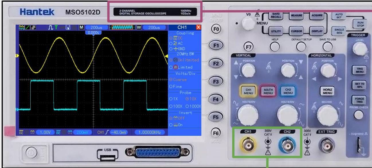
Tiene un ancho de banda de 100 MHz (señales de esa frecuencia comienzan a sufrir atenuaciones).
