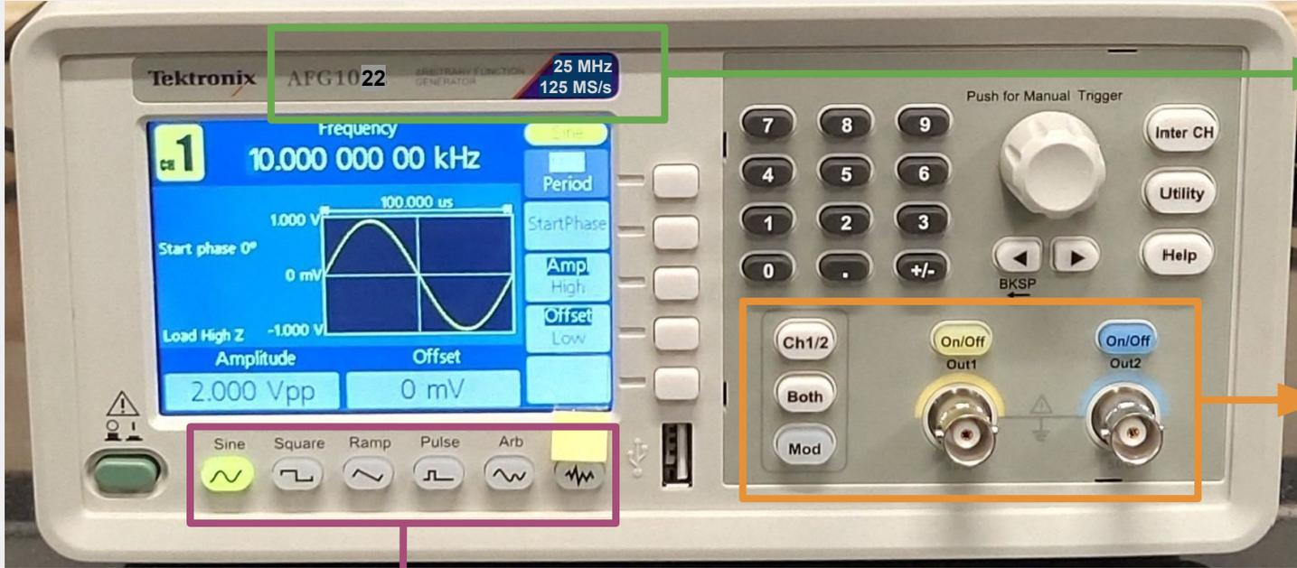
Tiene un ancho de banda de 25 MHz y puede generar 125 millones de 'puntos' por segundo.
