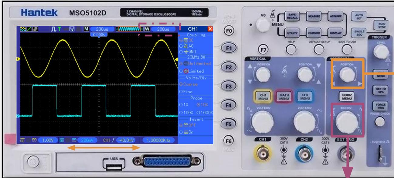
Controlamos la posición (horizontal) de la señal en la pantalla
