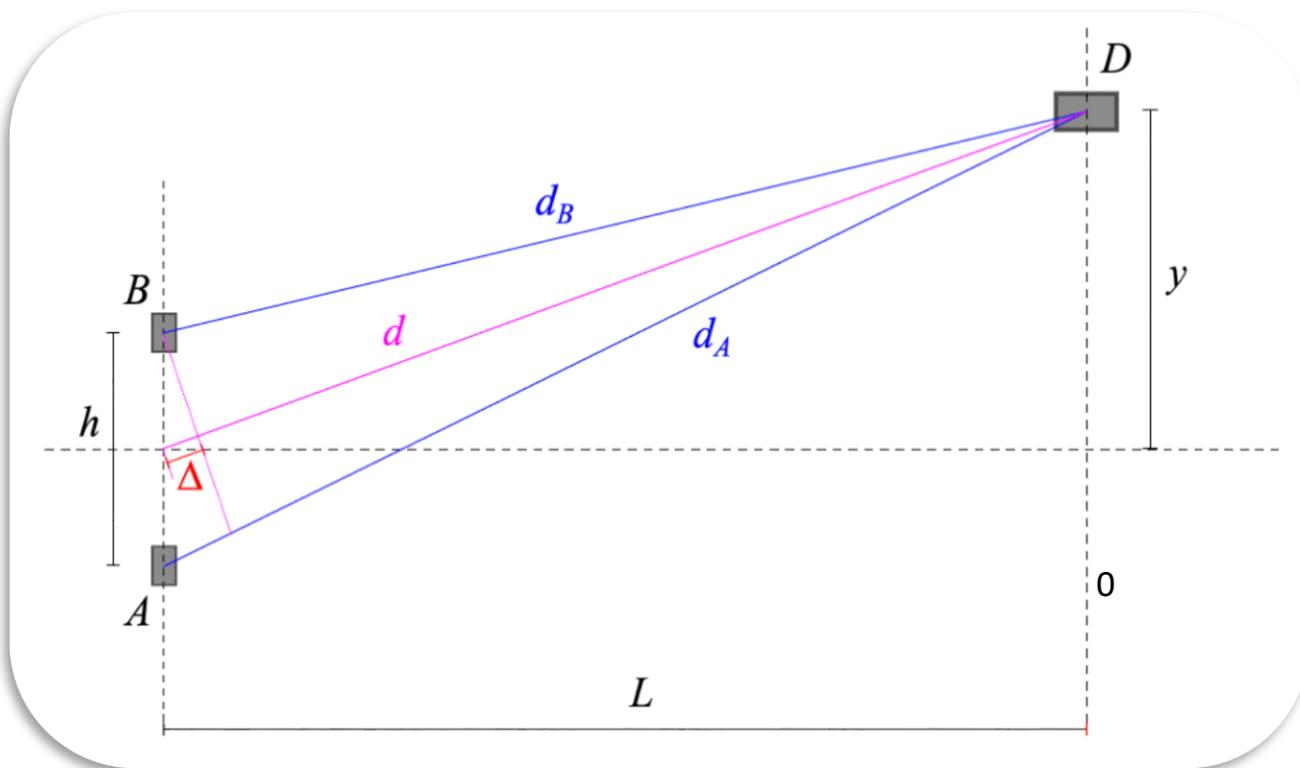
Se tienen dos emisores A y B separados por una distancia  $h$  y un detector D que puede desplazarse en línea recta (eje  $y$ ) sobre un plano situado a una distancia  $L$  perpendicular a la recta donde están los emisores.
