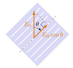
Poseen eje de transmisión, que permite el paso de la luz en estado de polarización paralelo a su eje
