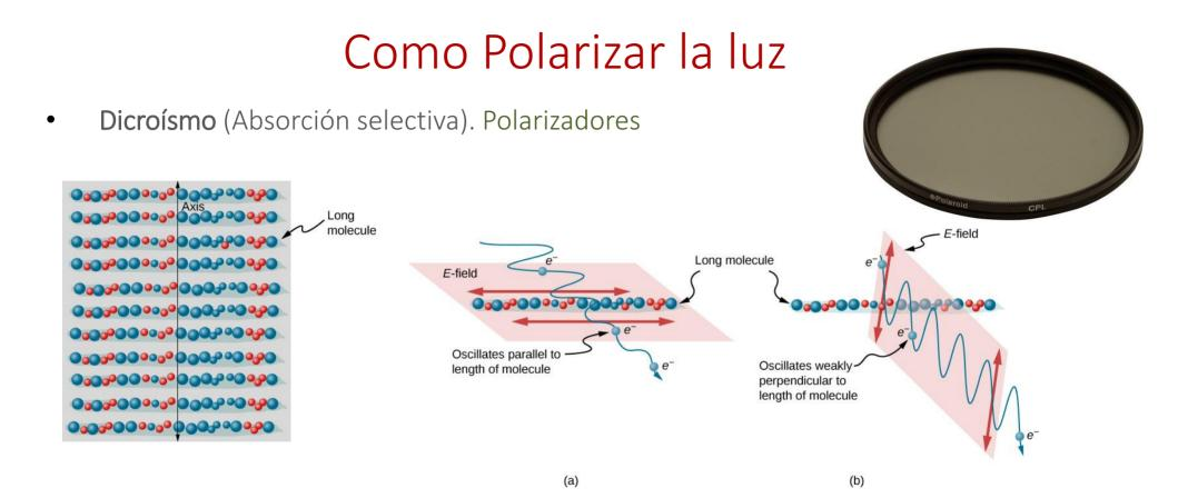
Poseen eje de transmisión, que permite el paso de la luz en estado de polarización paralelo a su eje
