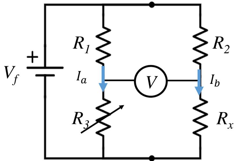
Medición de una resistencia  $R_x$
