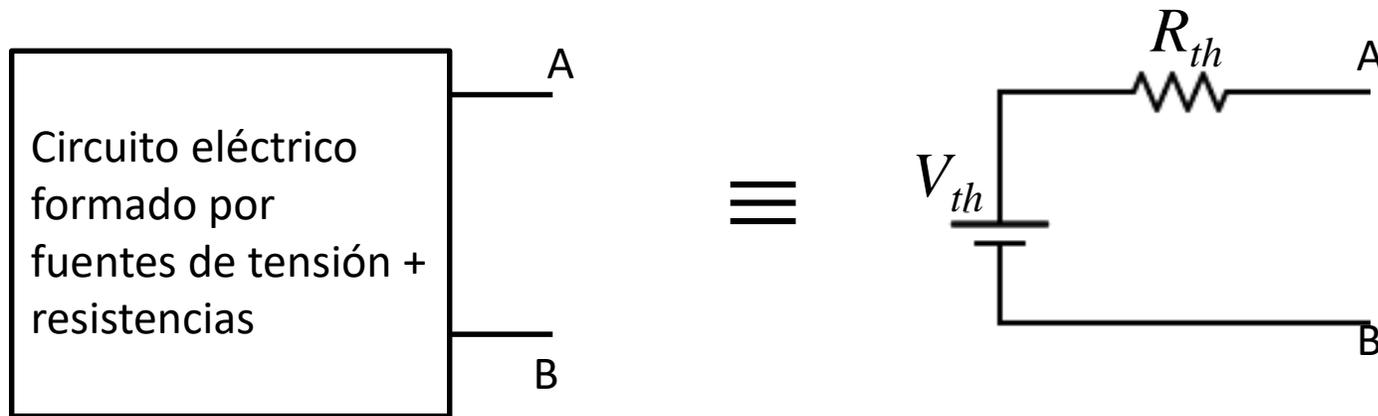
$V_{th}$  = tensión medida entre A y B a circuito abierto
