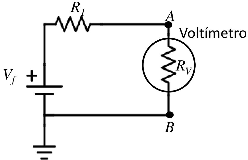
El voltímetro se conecta en paralelo entre  $A$  y  $B$  para medir la tensión entre esos puntos
