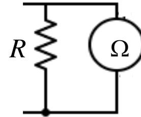
La resistencia debe estar desconectada del circuito. Utiliza una fuente interna (2.8V) y mide la diferencia de potencial entre los extremos de  $R$
