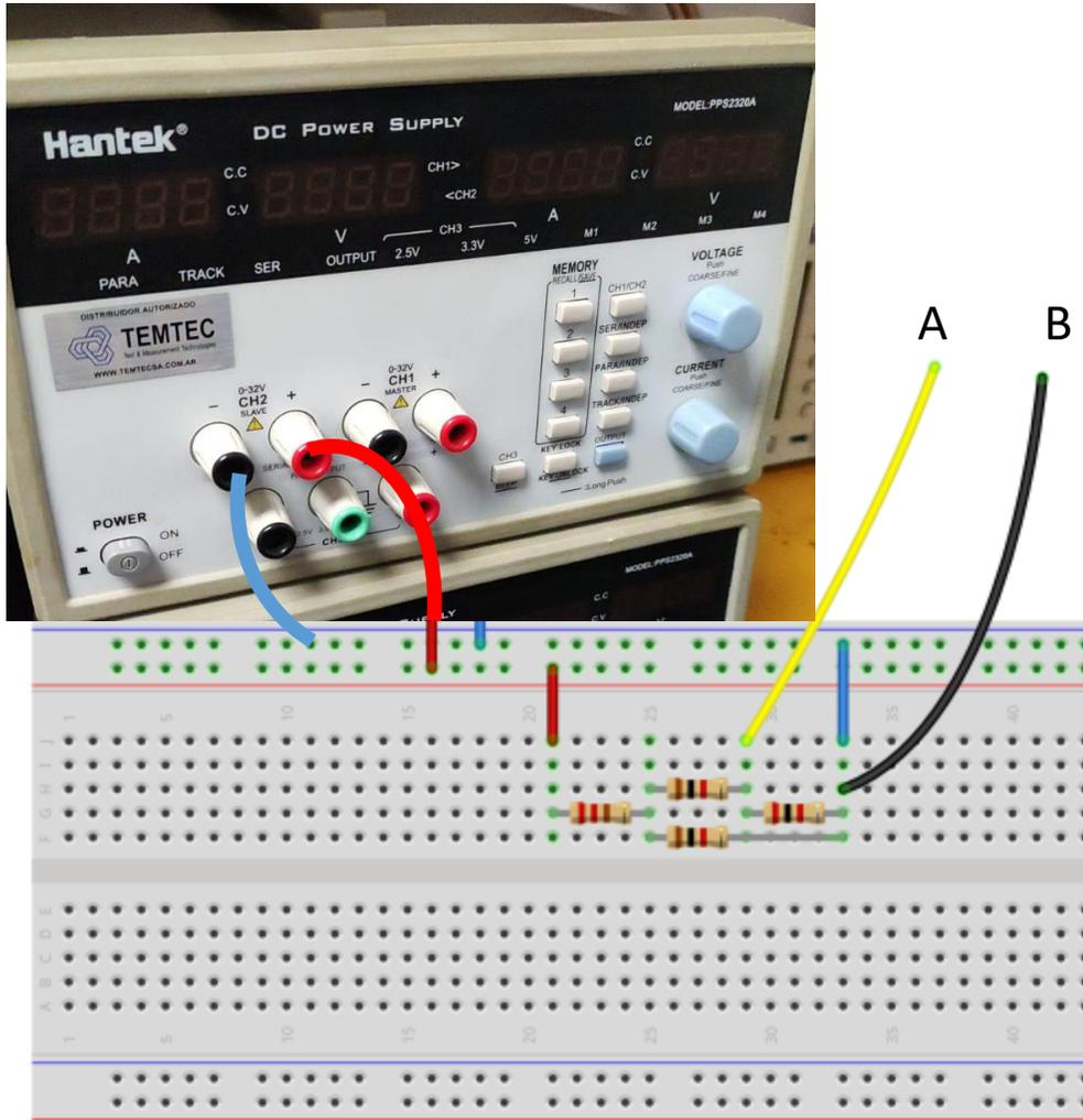
Emplear resistencias entre  $1\text{ k}\Omega$  y de  $10\text{ k}\Omega$
