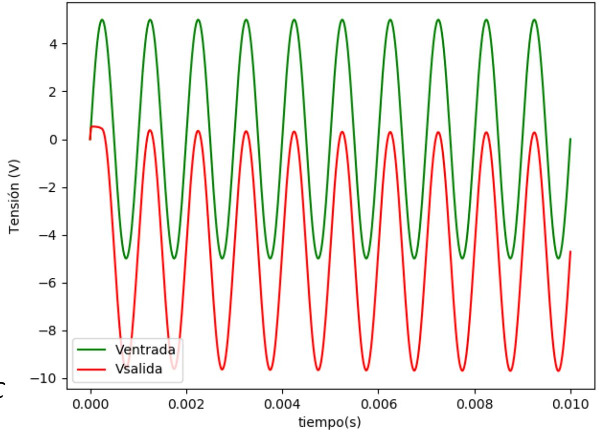
Amplitud de  $v$  : 5V;  $R \approx 1 \text{ k}\Omega$ ;  $C=100\text{nF}$
