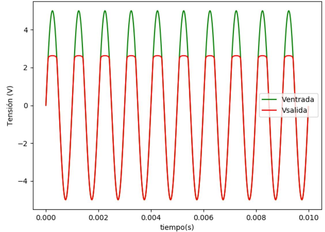
Amplitud de  $v$  : 5V;  $R \approx 1 \text{ k}\Omega$ ;  $E=2V$
