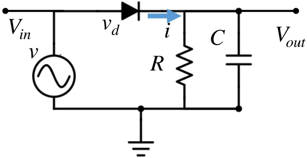
Amplitud de  $v$  : 5V;  $R \approx 1 \text{ k}\Omega$
