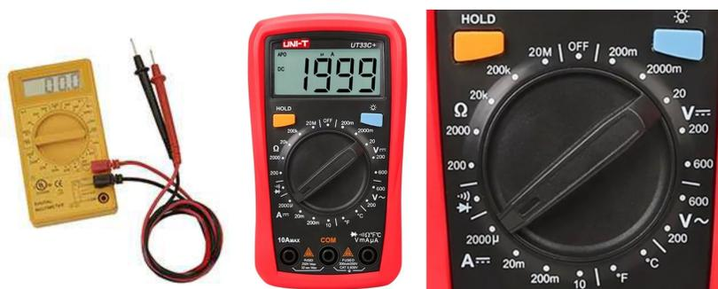
Figura 3: Ejemplos de multímetros y un acercamiento en la perilla de selección de funciones.
