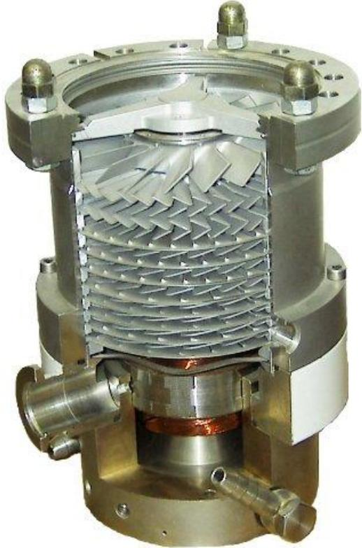
Las moléculas de gas son aceleradas de la cámara de vacío hacia una salida.
