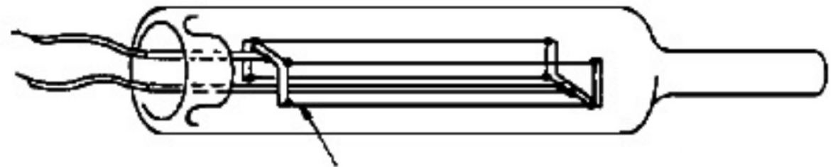
(b) Cuatro filamentos de tungsteno arrollados y conectados en paralelo
