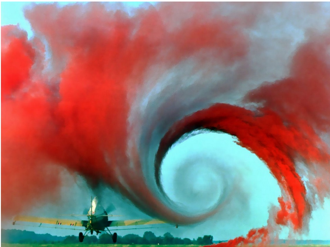
Figura 1: El vórtice debido al paso de las alas de esta aeronave, es visualizado a través de una técnica basada en la emisión de gas coloreado desde el suelo [1].
