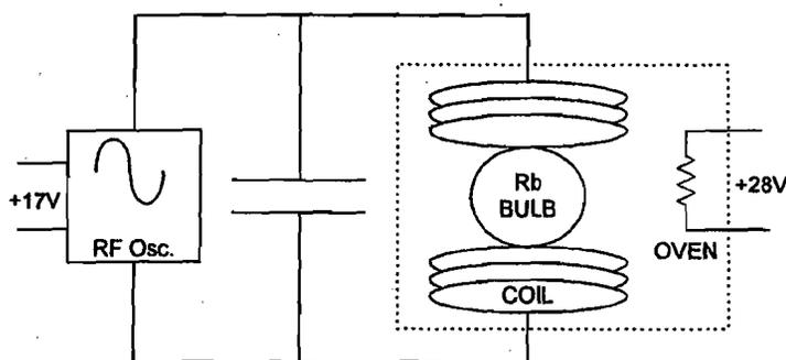
Figure 3A-1. a) Discharge Lamp
