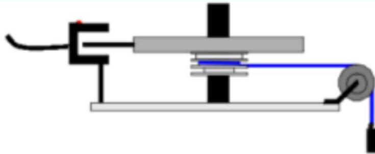
El hilo transmitirá al disco un torque y una aceleración angular controlados por el valor de las pesas.
