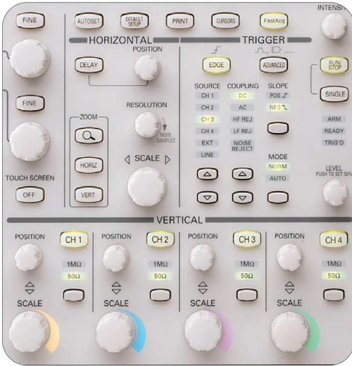
► Figura 22. Sección de control del panel frontal de un osciloscopio.
