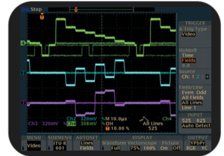
▶ Figura 58. El módulo de vídeo TDS3SD1 hace del osciloscopio de la Serie TDS3000 una herramienta rápida y completa para diagnóstico de vídeo.
