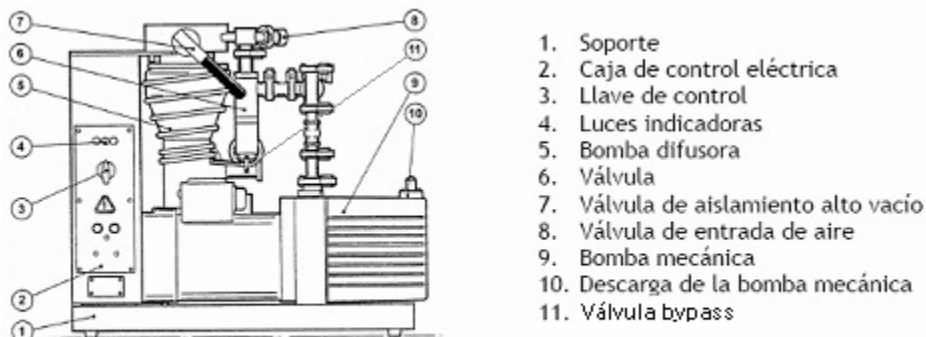
Figura 1: Sistema de vacío con bomba mecánica y difusora
