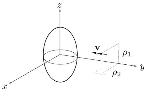
20. \*Una esfera homogénea de masa  $M$  y radio  $R$  está centrada en el origen. Una partícula de masa  $m$  se mueve con velocidad  $\mathbf{v} = -v_0 \hat{x}$  a lo largo de la recta definida por  $z = y = R/2$ . Cuando la partícula choca con la esfera queda pegada sobre su superficie. Describir el movimiento posterior del sistema si:
