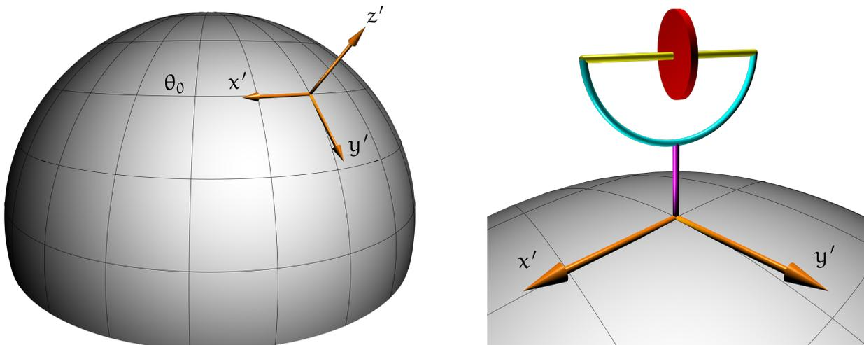
Respecto de estos ejes se definen los ángulos de Euler del giróscopo. Por hipótesis, el giróscopo está horizontal, de modo que  $\theta = \pi/2$ . Habrá únicamente dos coordenadas generalizadas,  $\varphi$  y  $\psi$ .
