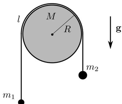
g) Una máquina de Atwood. Analice los casos en que la cuerda desliza y no desliza sobre la polea.
