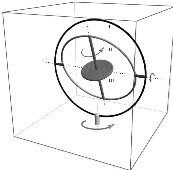
Los dos marcos tienen el mismo tensor de inercia respecto de su centro de masa, con momentos principales  $I_a = I_b$  e  $I_c = 2I_a$ . La peonza tiene momentos principales de inercia  $I_1 = I_2 \equiv I$  e  $I_3$  respecto de su centro de masa. El gir6scopo est1 centrado, de modo que los centros de masa de los tres elementos siempre est1n en reposo.
