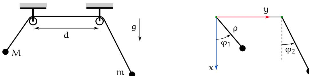
■ **Solución.** Ubiquemos el origen en la polea de la izquierda y definamos los ángulos  $\varphi_1$ ,  $\varphi_2$  y la distancia  $\rho$ , como muestra la figura de la derecha. Las posiciones de las partículas son
