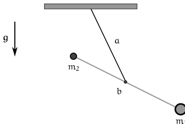
■ **Solución.** El punto de equilibrio que se pide analizar se muestra en la figura de la izquierda. A la derecha se muestra la elección de coordenadas generalizadas, de modo que en el equilibrio  $\varphi_1 = \varphi_2 = 0$ .
