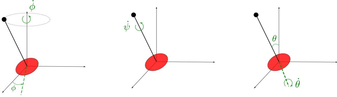
Figure 2: Rotaciones en los 3 ángulos de Euler.
