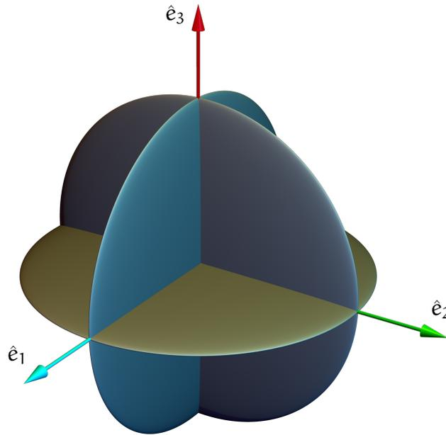
Que esto es así es debido a que el cuerpo tiene simetría de rotación respecto de estos tres ejes (rotaciones de ángulo  $\pi/2$ ). Veremos que se trata de una peonza simétrica, de manera que la elección de ejes principales dista de ser única. Para calcular los momentos de inercia principales, es suficiente con saber que el momento de inercia de un disco según su eje de simetría es
