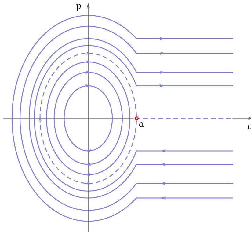
Hay dos regiones dinámicas: para energías  $E < V_0$  hay movimiento de libración. Para energía  $E > V_0$  y  $p \neq 0$  hay movimiento no acotado; cada órbita tiene en esa región un
