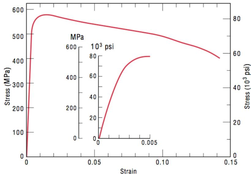
Figure 7: Curva esfuerzo deformación extraída del libro “Fundamentals of Materials Science and Engineering”. La figura pequeña inserta muestra la región lineal que está caracterizada por  $\sigma = E\epsilon$  pero la relación  $\sigma = \sigma(\epsilon)$  es mucho mas complicada.
