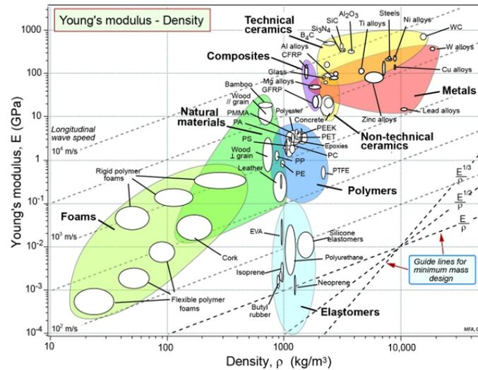
Figure 6: Diagrama de Ashby mostrando en un diagrama de rigidez-densidad los diferentes tipos de material. Al mover  $E/\rho$
