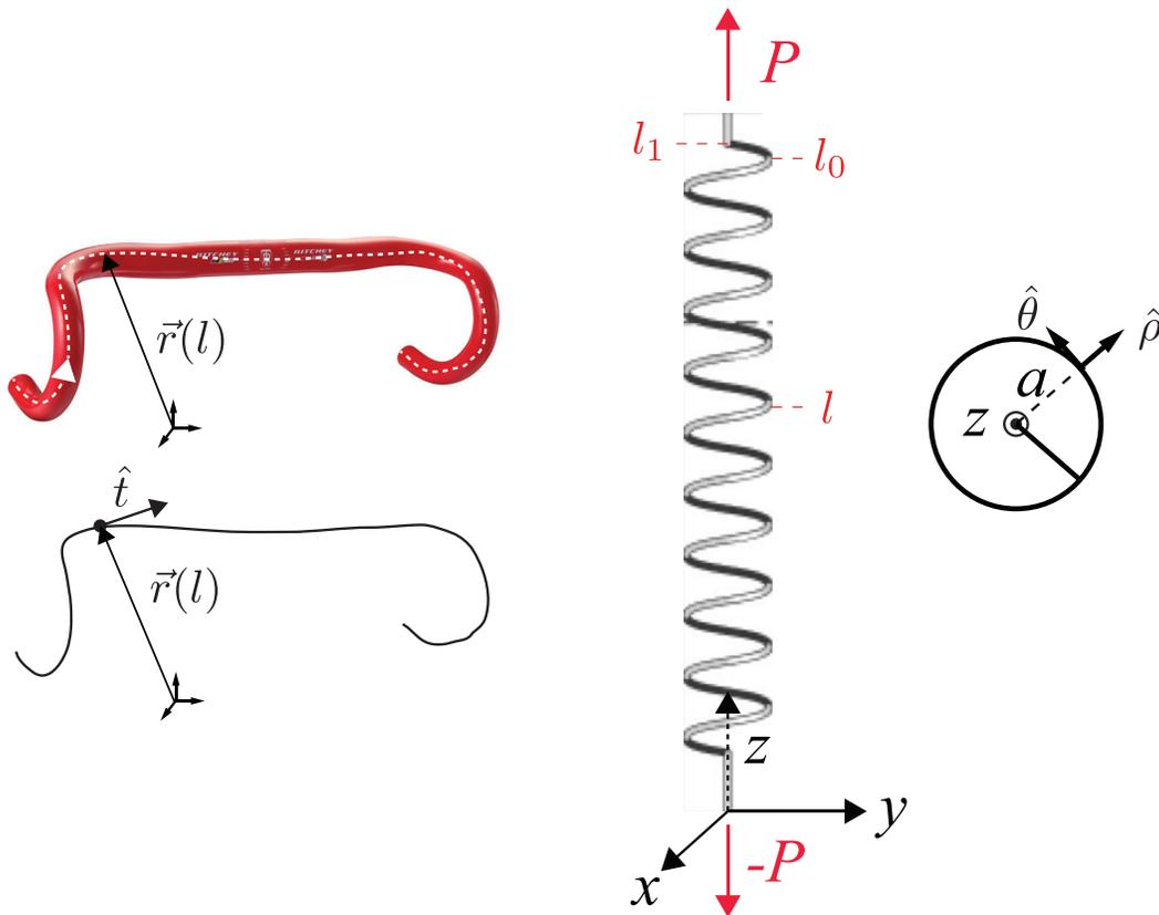
Figure 2: Izquierda: Definición de la línea media en el manubrio de una bicicleta. Derecha: Configuración para un resorte muy rígido en el cual las espiras están casi en contacto una con otra antes de la deformación, es decir  $\hat{t} \approx \hat{\theta}$
