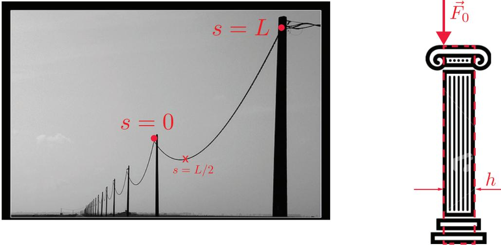
Figure 1: Izquierda: Cable eléctrico deformado en forma de catenaria debido a su propio peso. Derecha: Columna sometida a una carga sobre su borde lo cual genera momentos peligrosos.
