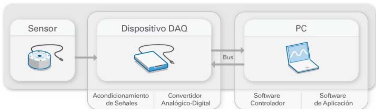
Figura 1: Partes de un sistema DAQ.
