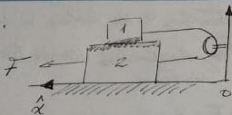
La caja 1 se mueve de Izq a Derecha ( $\ddot{x}_1 < 0$ ) y la 2 de Derecha a Izq ( $\ddot{x}_2 > 0$ )
