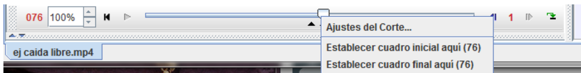
Figura 2: Selección del rango de la filmación. A la derecha, se indica cada cuantos cuadros se va a registrar una medición. En este caso la medida se realiza cada 1 cuadro.
