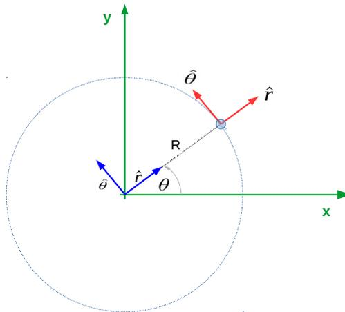
Figure 2: Un móvil (pelota) describe una trayectoria circular de radio  $R$ . Sistema de coordenadas cartesiano definido desde el centro de la circunferencia y coordenadas polares.
