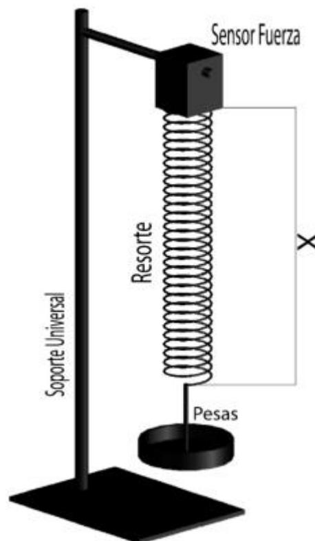
**Figura 1.** Montaje experimental propuesto la Parte 1.
