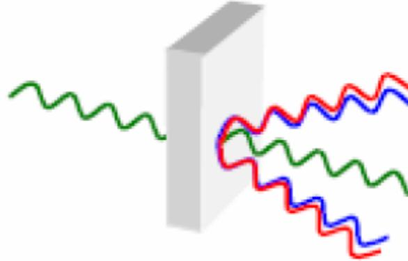
$$\vec{P}_0(\vec{r}, t) = \tilde{\chi}_0(\vec{k}_i, \omega_i) \vec{E}_i(\vec{k}_i, \omega_i) \cos(\vec{k}_i \cdot \vec{r} - \omega_i t) \quad \text{Dispersión Rayleigh}$$
