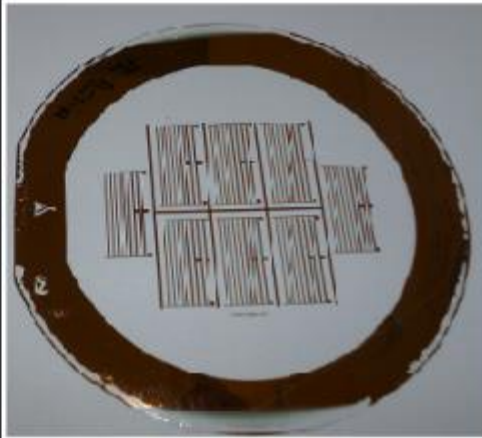
(b) Oblea con electrodos depositados con técnica litográfica positiva
