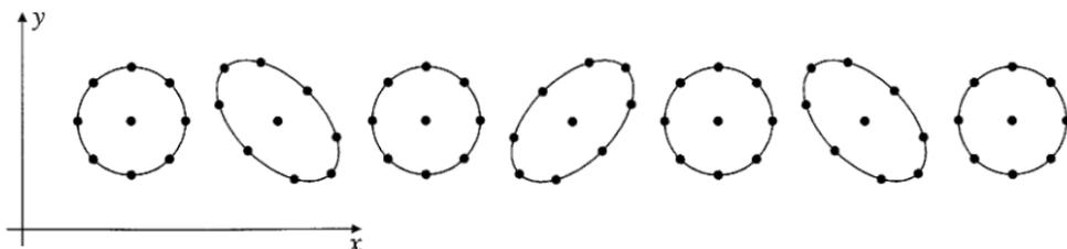
El punto b) del problema nos da una idea de cómo detecta un interferómetro tipo LIGO el paso de una onda gravitatoria.
