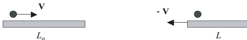
En la Figura de la izquierda se describe el movimiento relativo en el sistema fijo a la barra, mientras que la Figura de la derecha lo describe en el sistema fijo a la partícula. Como no estamos dispuestos a prejuzgar sobre la naturaleza del espacio y el tiempo, hemos dibujado la barra con distintas longitudes en cada sistema. Llamamos *longitud propia*  $L_0$  a la longitud de la barra en el sistema donde se encuentra en reposo. El tiempo
