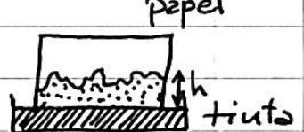
El crecimiento es proporcional a la tasa de deposición  $d\lambda$  x u. de área. Pero la superficie crece en la dirección normal a la sup., no en la dirección de la altura.
