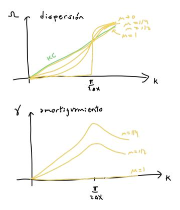
Cómo  $\Omega/k \neq c$  los modos se propagan con diferente velocidad (deberían propagarse todos con velocidad c)
