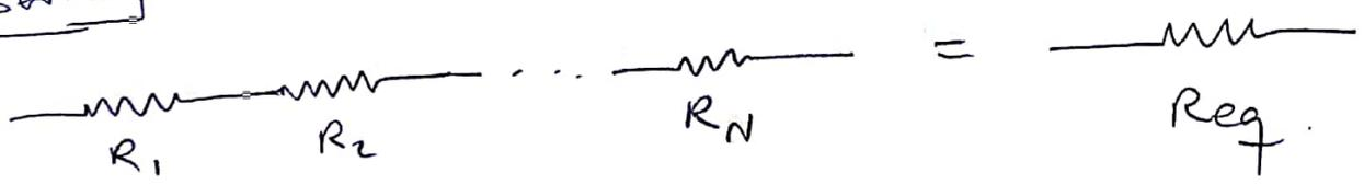
con  $R_{eq} = R_1 + R_2 + \dots + R_N$
