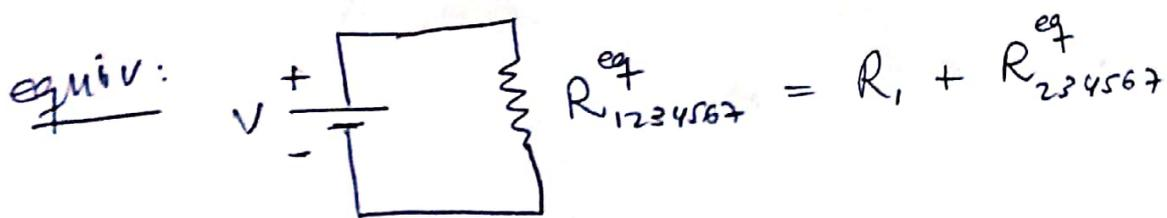
Si quiero calcular la corriente que atraviesa la fuente, o una dada resistencia, puedo reemplazar las otras resistencias por sus equivalentes. Cuando reemplazo, pierdo noción de la corriente que atraviesa la resistencia reemplazada.
